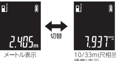
※10/33m(尺相当換算)表示は、距離測定時とメモリー呼び出し時のみ使用できます。面積測定時にはm<sup>2</sup>、体積測定時にはm<sup>3</sup>に単位が切り替わります。
